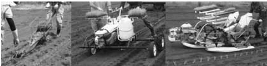
図11 雑穀の移植機（左：簡易移植機、中：半自動移植機、右：ポット成苗田植え機）
